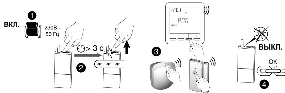
**RU** ❶ Включить электропитание для установки. ❷ Нажать и удерживать нажатой в течение 3 секунд кнопку радиопередатчика, пока его индикатор не начнёт мигать. Отпустить кнопку. ❸ На терmostate выполнить запрос на привязку по радиоканалу (см. руководство). ❹ Проверить, что индикатор радиопередатчика больше не мигает. Привязка радиопередатчика и терmostата успешно завершена.
